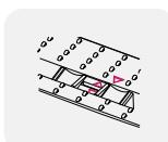
Оптический датчик должен быть установлен в центральном положении под наклейкой.
